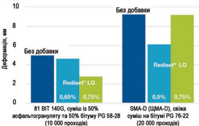
Бітум, що містить Rediset® LQ, характеризується більш високим опором деформації та підвищеною вологостійкістю. Дані випробувань отримано на стенді з гамбурзьким колесом з Чиказької випробувальної лабораторії та Pavetex, США. Випробування проводились на основі AASHTO T 324.
