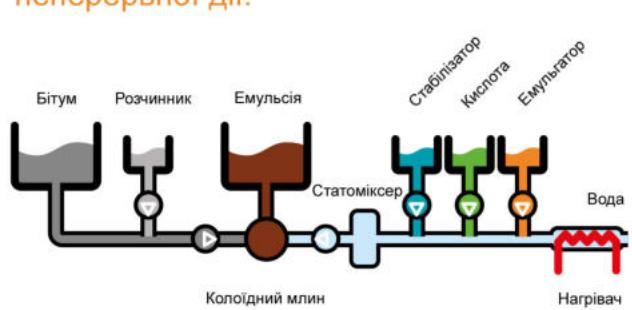
Можливим є і застосування різних спеціальних добавок, наприклад, латексу (що є водною дисперсією блок-співполімеру стирену, бутадієну та каучуку (SBR)) або сухої порошкоподібної полімерної добавки до бітуму (що є блок-співполімером «стирен-бутадієн-стирен» (SBS)). Реалізація функції введення таких добавок потребуватиме до-облаштування емульсійної установки спеціальними додатковими функціональними компонентами та використання спеціальних конструктивних/технічних рішень. Наприклад,
