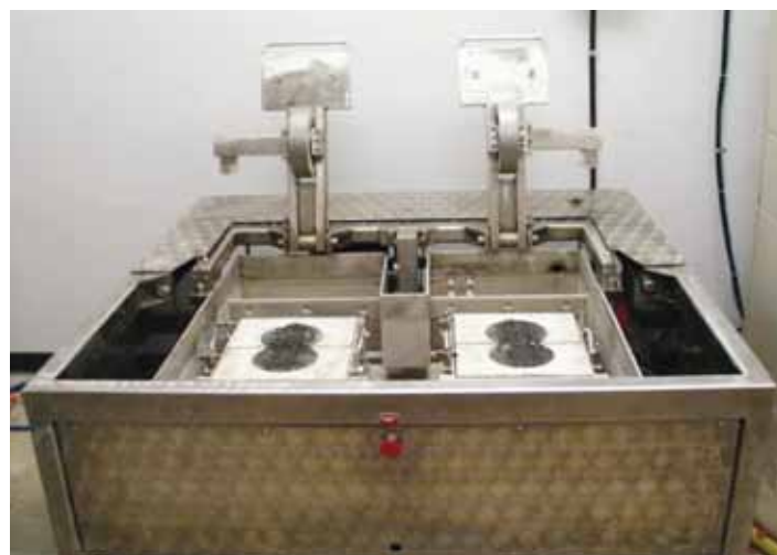
Испытание на стенде с гамбургским колесом.
