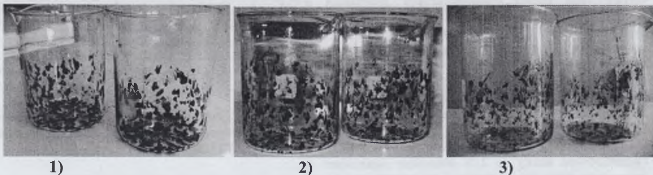
1 – ЩМАС-15 на вихідному бітумі БНД 90/130 при 0,30 % Antrocel G; 2 – ЩМАС-15 на модифікованому бітумі при 0,30 % Antrocel G; 3 – ЩМАС-15 на модифікованому бітумі при 0,40 % Antrocel G
